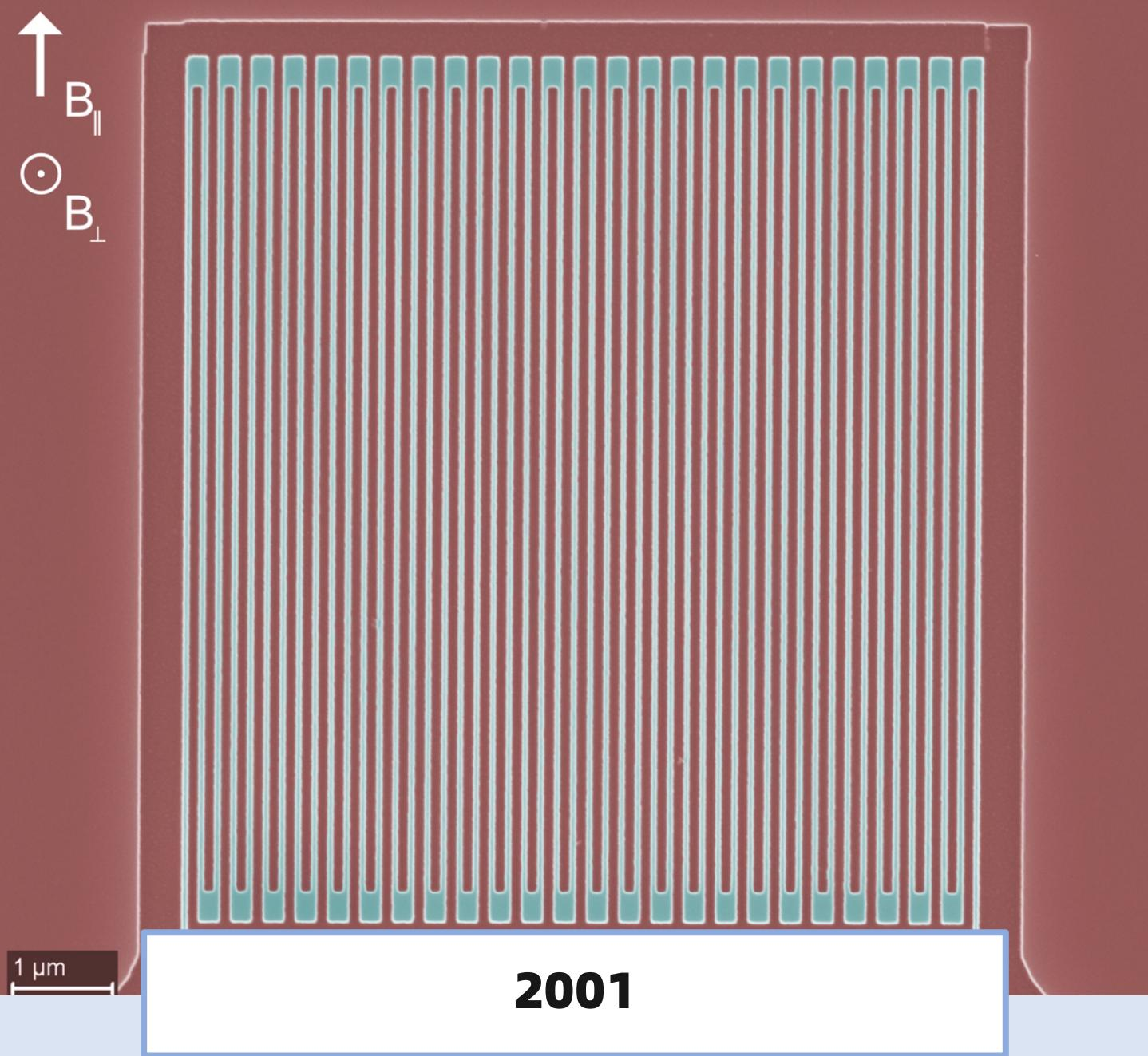
莫斯科国立师范大学和罗切斯特大学的科学家于 2001 年开发了超导纳米线单光子探测器。超导纳米线单光子探测器的基本原理是将这些载流子对转化为一个可观测的电信号，从而检测到单个光子的存在。这在量子通信、光学成像等多个场景有广泛应用。
